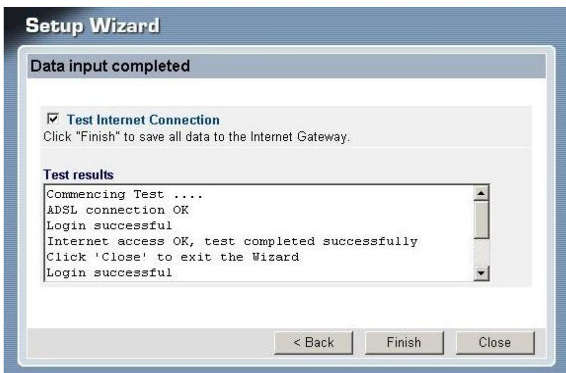
Затем появляется окно проверки интернет соединения, при этом на модеме должны гореть следующие индикаторы: power, dsl, internet и какой-нибудь из LAN портов или WLAN.
